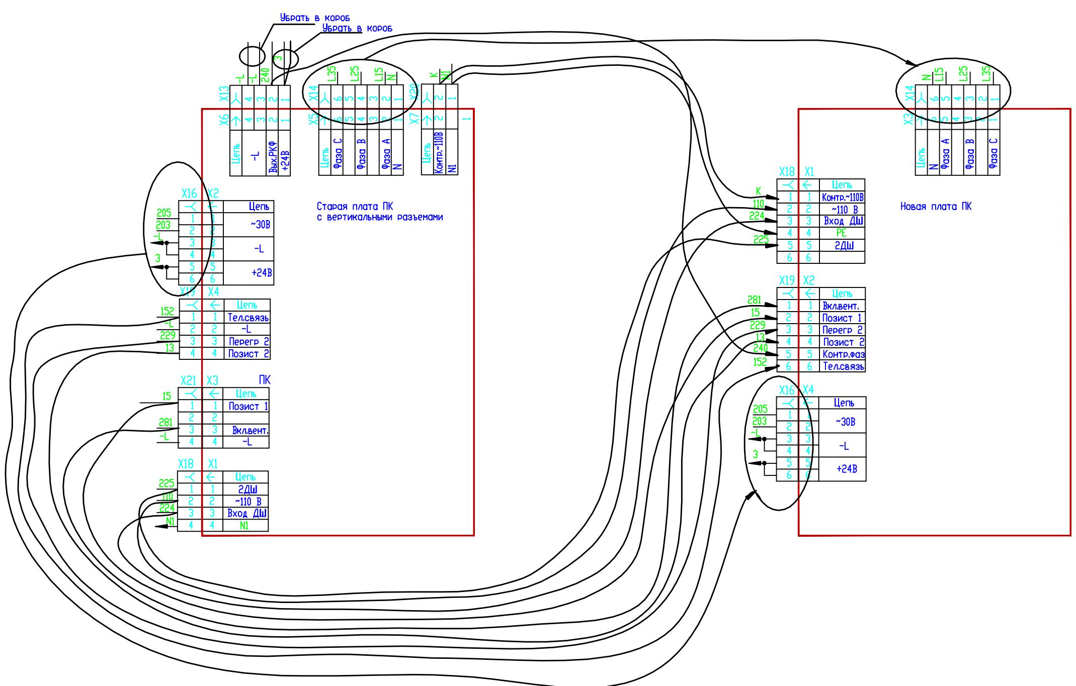
При перекоммутации со старой платы ПК (УИРФ.469135.041) на новую ПК (УИРФ.469135.041-01) необходимо учитывать, что при подключении внешнего разъема на плату ПК с горизонтальными разъемами 1-ая ножка внешнего разъема подключается к последней ножке разъема на плате.. С учетом этого факта перекоммутация производится следующим образом:
