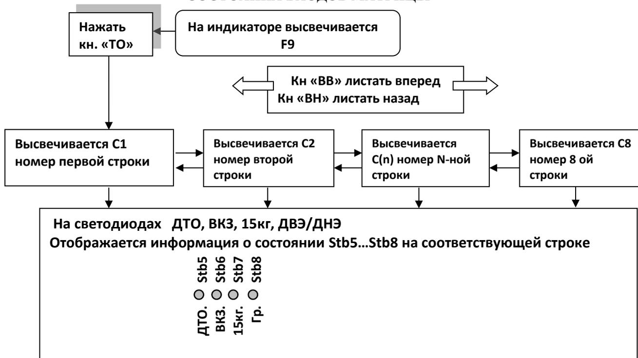
Для выхода из режима программирования можно нажать одновременно кнопки «ВВ» и «ВН» или переключить режим работы на пульте управления
