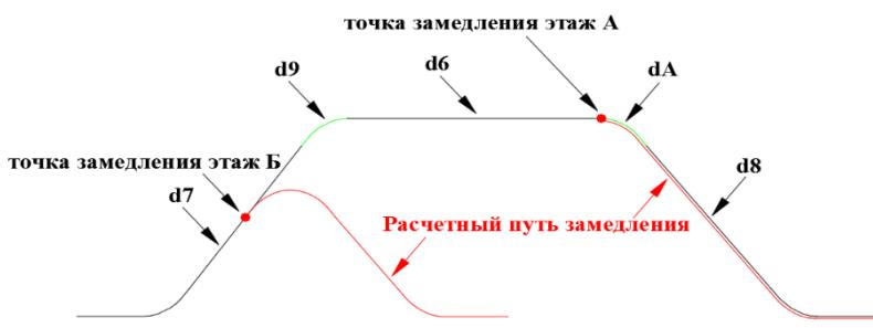
Эти параметры платы ЦПУ-2 влияют только на формирование точки начала замедления. В зависимости от расстояния до этажа в импульсах, записанных при настроечном рейсе (обучающем прогоне) и характеристики разгона/ торможения настроенной в частотном преобразователе, процессор математически
