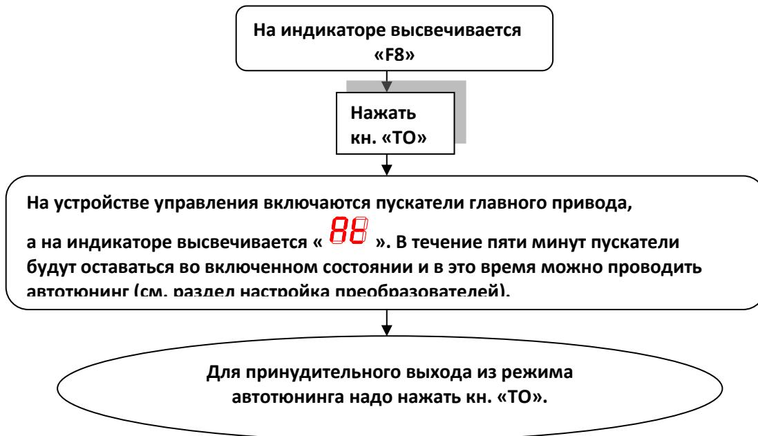
При использовании этого режима отпадает необходимость при проведении автотюнинга вытаскивать реле аварии и вручную принудительно включать пускатели главного привода.
