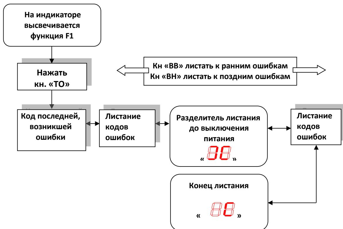
Для быстрого перехода в начало листания можно нажать кн. «TO». Для выхода на предыдущий уровень можно нажать одновременно кнопки «ВВ» и «ВН» или переключить режим работы на пульте
